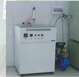
低温脆性试验 Low-temperature brittleness test испытание холодной хрупкости
