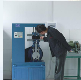
屈挠龟裂试验 Flexing test испытание на растрескивание резинового есания
