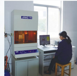
橡胶硫化仪 Vulcanometer резинный сульфидный прибор
